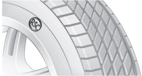
نشان RSC بر روی بدنهٔ تایر قابل رویت باشد.
